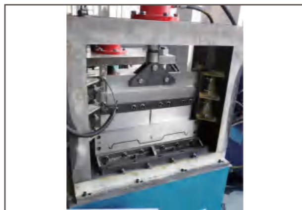
液压带废料切断
